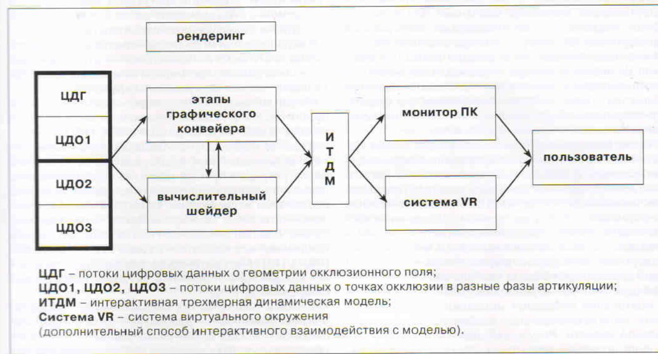
Рис. 1. Принципиальная схема основных этапов технологической цепочки построения виртуальной динамической модели программно-аппаратным способом
